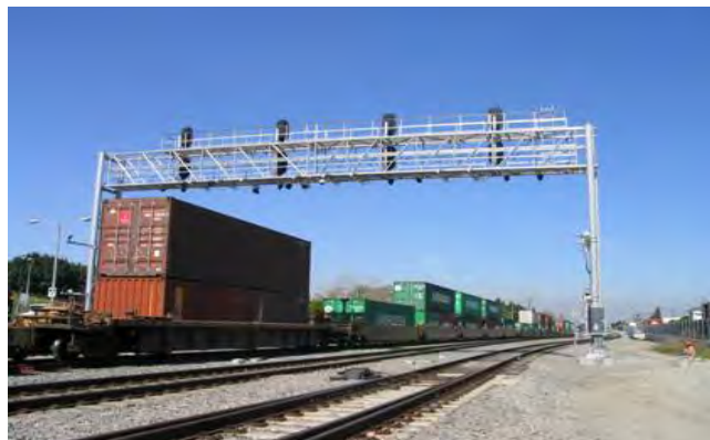
شکل ۲- سیستم شناسایی کانتینر بر روی ریل
